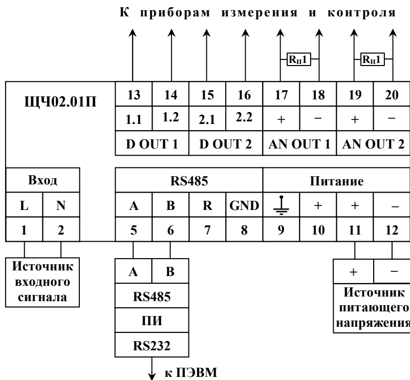
Рисунок Б.3 – Схема подключения приборов ЩЧ02.01П
